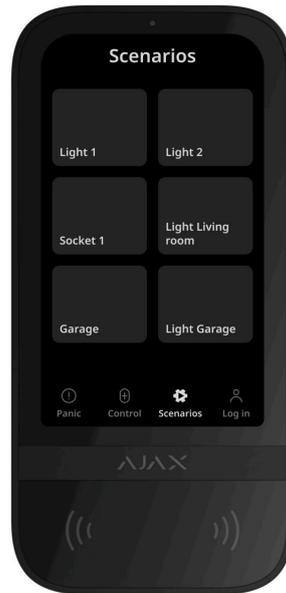
Het afzonderlijke tabblad voor het bediendeel kan tot zes knoppen bevatten waarmee één automatiseringsapparaat of een groep apparaten kan worden bediend. Groepsscenario's bieden een eenvoudige bediening van meerdere schakelaars, relais, of stopcontacten tegelijk.
