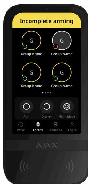
Superior KeyPad TouchScreen Fibra kan deelnemen aan tweefasige inschakeling, maar kan niet als tweede-fase-apparaat gebruikt worden. De tweefasige inschakelprocedure met Tag, Pass, of een smartphone is vergelijkbaar met de inschakeling met een persoonlijke of gemeenschappelijke code op het bediendeel.
