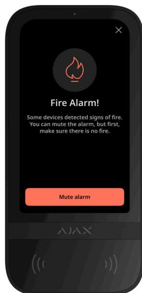
In geval van een brandalarm in het systeem, kunt u deze dempen met Superior KeyPad TouchScreen Fibra.
