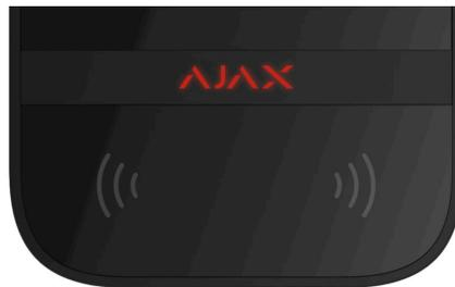
Het bediendeel kan meldingen geven over de activering van het ingeschakelde systeem aan de hand van een led-indicatie.
