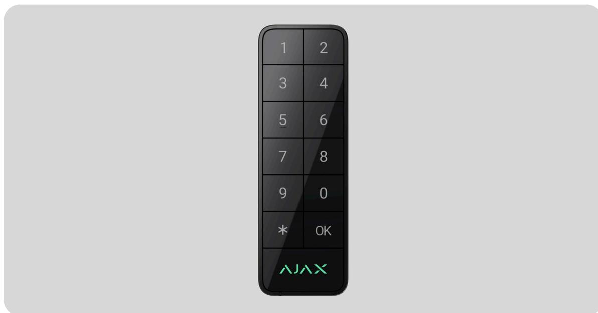
**Superior KeyPad Outdoor Fibra** is een bekabeld bediendeel voor het beheren van het Ajax-systeem. Gebruikers kunnen zich authenticeren met smartphones, Tag-sleutelhangers, Pass-kaarten, en codes. Het apparaat is bedoeld voor gebruik binnen en buiten en voldoet aan de eisen van EN 50131 (Grade 3).
